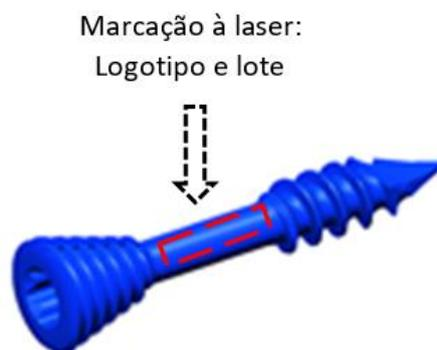
Figura 3- Região da gravação no parafuso
