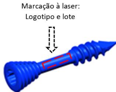
Figura 5- Região da gravação no parafuso
