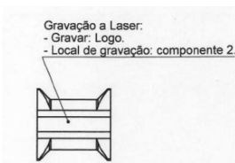
Figura 12 – Identificação da região de gravação à laser.
