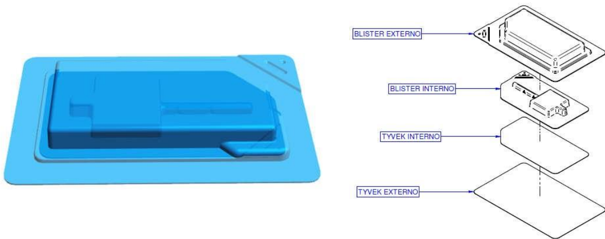
Figura 3 – Representação do blister selado e sua ordem de montagem
